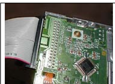
کابل فلایپی درایو یک تاب مشخصی دارد.
